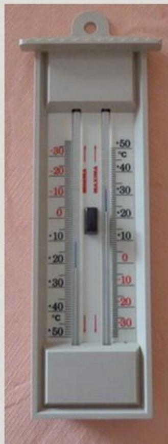
C'est un thermomètre à alcool dont le capillaire en forme de U avec un bulbe de mesure à gauche et à droite une ampoule qui permet l'expansion de l'alcool. Le bas du U contient une colonne de mercure au-dessus de laquelle deux index peuvent glisser dans le capillaire. Ces index sont en fer émaillé et à l'arrière du thermomètre on place une plaque faiblement aimantée.
