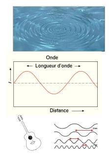
Quand on jette un caillou dans l'eau, des vagues concentriques s'en écartent. On vient de fabriquer une onde... Celle-ci, observée de côté, donne un profil semblable à des vagues
